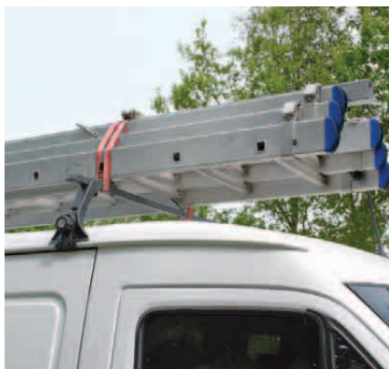
Einteilige Zurrgurte eignen sich gut zur Sicherung von Dachlasten.
