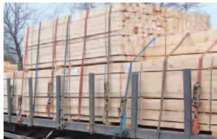
Zweiteilige Zurrgurte werden hauptsächlich zum Niederzurren eingesetzt.
